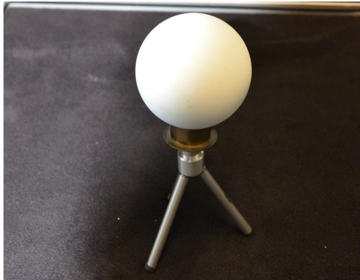
Abbildung 22: Kugelnormal. Edelstahl, matt weiß lackiert, \phi = 100 \text{ mm} , U = 1,6 \text{ }\mu\text{m}
