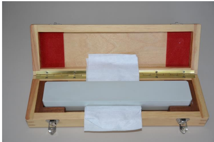
Abbildung 24: Keramik-Messbalken. Messbalken 300 \times 50 \times 40 \text{ mm}^3 , U = 1,0 \mu\text{m} optisch kooperative Keramik
