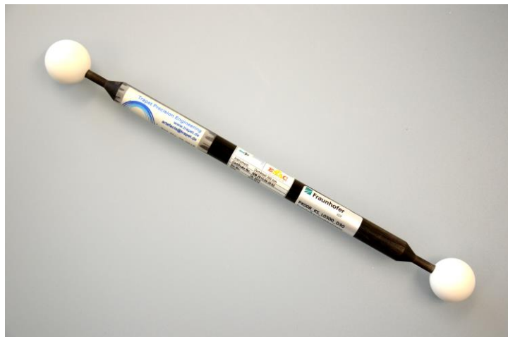
Abbildung 23: Kugelstab. CFK-Kugelstab mit weiß lackierten und geläpften Kugeltargets, L = 300 \text{ mm} , D = 30 \text{ mm}
